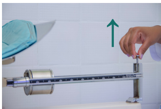
Figura 2 - Aferição de peso de crianças menores de 2 anos em balança pediátrica mecânica.
