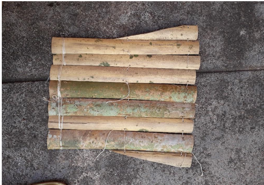
Figura 8. Aspecto inicial após fixação das tiras com o fio nylon retorcido – usando os foros ou amarrando sobre as tiras.
