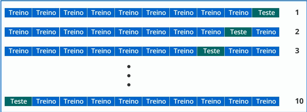
Figura 2 - Representação do método k-fold de validação cruzada
