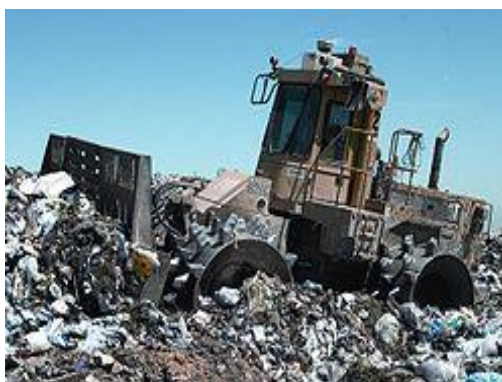
Figura 7. Um compactador de resíduos (autor Ropable).
